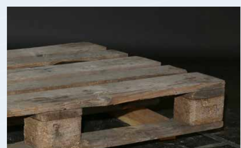
Keine vorgeschriebene Kennzeichnung mehr lesbar
