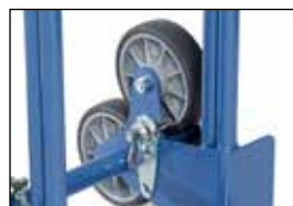
Stern-Feststeller 1770 als Anbausatz für TK1325 und TK1326 . Stern-Feststeller dienen zur problemlosen Fahrt auf 2 Rädern auf ebener Strecke. Leichte Selbstmontage.
