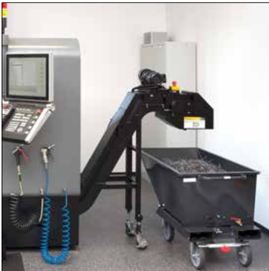
Anwendungsbeispiel: Muldenkipper als Spänebehälter
