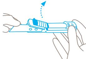
Klinge an der **stumpfen** Seite anfassen und mit ihrer Hilfe die Klingenabdeckung nach oben hebeln. Die Abdeckung verbleibt in der geöffneten Stellung.
