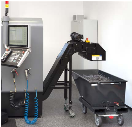
Anwendungsbeispiel: Muldenkipper als Spänebehälter
