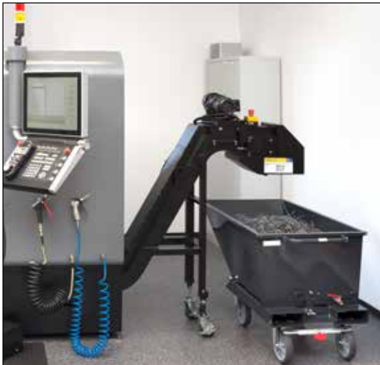
Anwendungsbeispiel: Muldenkipper als Spänebehälter
