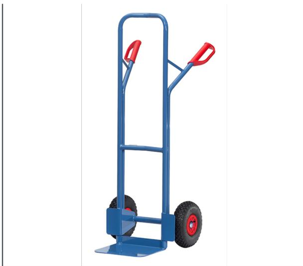
Stahlrohr-Stapelkarre mit Stahlblechschaufel, stabile Schweißkonstruktion, pulverbeschichtet, blau RAL 5007. Sicherheitsgriffe. Stahlblechschaufel anschraubbar und dadurch austauschbar. Räder mit Luftbereifung, auf Kunststoff-Felgen, Naben mit Rollenlagerung. Bügel oben und Querstreben durchgebogen. Für den sicheren Transport von runden Gütern, wie Rollen, Kannen, Eimern usw. Zerlegte Anlieferung.
