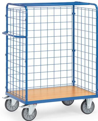
Baukasten-System, Stahlrohr und Profilstahl geschweißt, pulverbeschichtet blau RAL 5007, Schraubkonstruktion. Stirnwände und eine Längswand geschlossen mit Drahtgitter 100 x 100 x 5 mm. Plattform Holzwerkstoffplatte, Oberfläche Buchendekor. Berädern: 2 Lenk- und 2 Bockrollen, TPE-Bereifung, Naben mit Rillenkugellager. Feststeller an den Lenkrollen, gemäß der europäischen Norm EN 1757-3 (Sicherheit von Plattformwagen).
