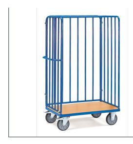
Baukasten-System, Stahlrohr und Profilstahl geschweißt, pulverbeschichtet blau RAL 5007, Schraubkonstruktion. Stirnwände mit vertikalen Rohrstreben im Abstand von ca. 130 mm. 1 Längswand zum Einhängen. Plattform Holzwerkstoffplatte, Oberfläche Buchendekor. Beräderung: 2 Lenk- und 2 Bockrollen, TPE-Bereifung, Naben mit Rillenkugellager. Feststeller an den Lenkrollen, gemäß der europäischen Norm EN 1757-3 (Sicherheit von Plattformwagen).
