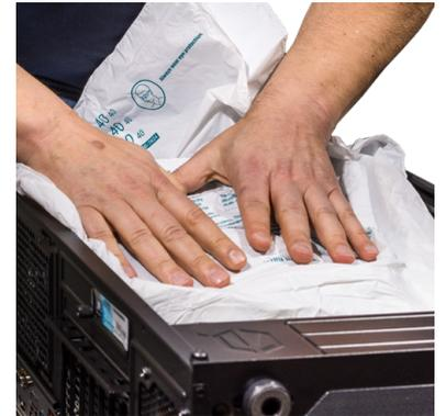
Dann legen wir den Beutel großflächig um die Bauteile herum, während sich der Schaum im Inneren bereits langsam ausbreitet.
