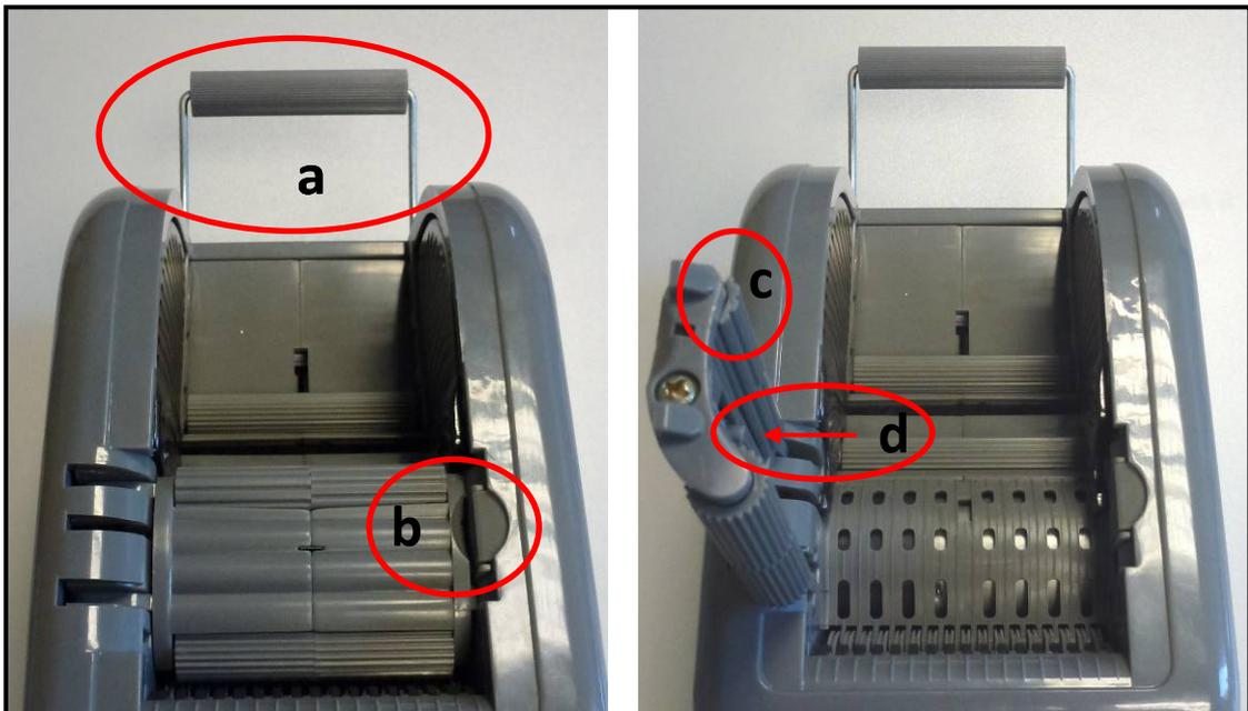
Falls Sie mit dem Gerät Klebebänder verarbeiten möchten, die sich relativ leicht abwickeln lassen, so können die hinteren Laufrollen (c) durch die angebrachten Hebel (d) festgestellt werden. Somit wirken diese wie eine Umlenkung und bringen etwas Spannung auf das Klebeband.
