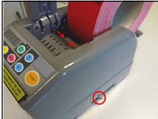
4. Klebebandende auf die untere Förderwalze andrücken und anschließend die obere Fördereinheit wieder schließen (rastet ein).
