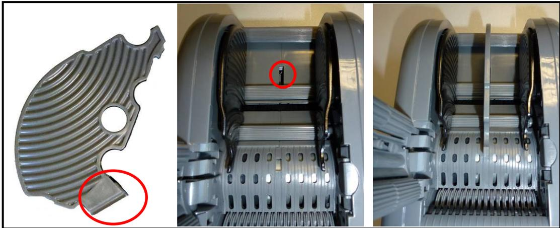
3. Klebebandrolle einlegen und Zentrierungsplatten durch seitlichen Schieber andrücken (niemals oben an den Platten selbst drücken!!!):
