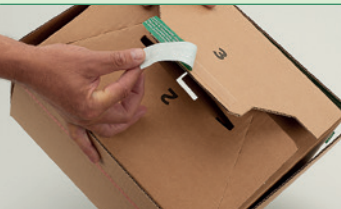
Bodenlaschen nach innen, Verschlusslaschen mit progress-Selbstklebeverschluss verkleben
